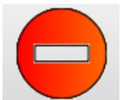
Обратите внимание! Если станок делает что-то не то ( уперся в край и трещит ), быстро нажимайте кнопку СТОП. Ситуация заклинивания неприятна как для механики, так и электроники привода.
