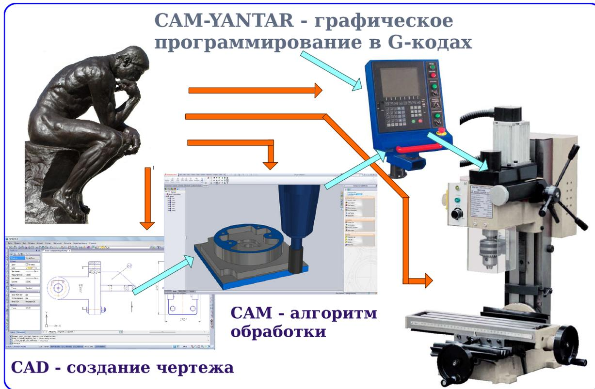
Промышленный путь разработки программ ЧПУ предполагает приобретение и освоение громоздких и супердорогих программ CAD-CAM. Типично, процесс создания управляющей программы (УП) для станка в G-кодах включает разработку чертежа в CAD -системе, с последующим преобразованием препроцессором в текстовый файл УП. В результате решение простых практических задач выливается в многочасовое изучение ассортимента и обширных возможностей монстров типа Autocad, SolidWorks и т. д.
